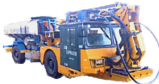
**Машина МСЗП-4** предназначена для зарядания вертикальных и наклонных скважин диаметром от 60 мм до 120 мм, глубиной до 40 м с углом наклона к горизонту от 0° до 90° при очистных и добычных работах ЭВВ «Сибирит-800Ш», изготавливаемом в процессе зарядания путем смешения эмульсии «Сибирита» с ГГД.
