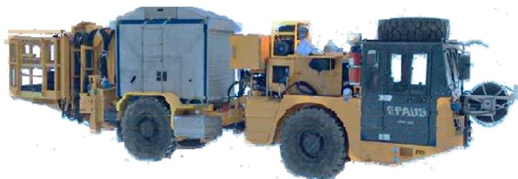
**Модуль зарядный подземный МП-1600** предназначен для зарядки горизонтальных шпуров (уклон не более 5°) диаметром от 36 до 76 мм глубиной до 6 м при проходческих, очистных и добычных работах эмульсионным взрывчатым веществом (ЭВВ) «Сибириты -700Ш и -800Ш». изготавливаемым в процессе зарядания путем смешения эмульсии «Сибирита» с одной или двумя газогенерирующими добавками (ГГД).
