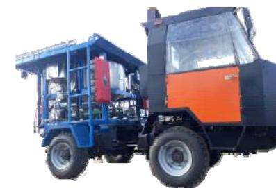
**Машина подземной проходки МП-500** изготовлена на базе шасси МД-08 (производитель Республика Беларусь). Область применения – в подземных шахтах и рудниках не опасных по газу и пыли, для зарядки горизонтальных и наклонных (до 5°). шпуров глубиной до 6м и диаметром 36-76 мм.
