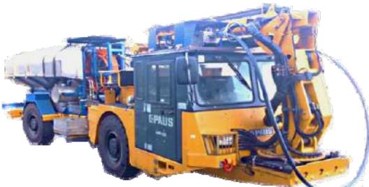
**Машина МСЗП-4** предназначена для заряжания вертикальных и наклонных скважин диаметром от 60 мм до 120 мм, глубиной до 40 м с углом наклона к горизонту от 0° до 90° при очистных и добывающих работах ЭВВ «Сибирит-800Ш», изготавливаемом в процессе заряжания путем смешения эмульсии «Сибирита» с ГГД.
