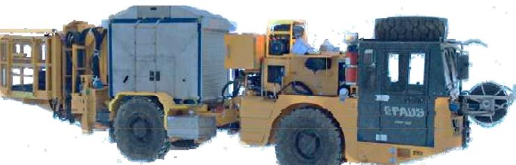
**Модуль зарядный подземный МП-1600** предназначен для заряжания горизонтальных шпуров (угол не более 5°) диаметром от 36 до 76 мм глубиной до 6 м при проходческих, очистных и добывающих работах эмульсионным взрывчатым веществом (ЭВВ) «Сибириты -700Ш и -800Ш». изготавливаемым в процессе заряжания путем смешения эмульсии «Сибирита» с одной или двумя газогенерирующими добавками (ГГД).
