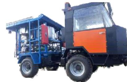
**Машина подземной проходки МП-500** изготовлена на базе шасси МД-08 (производитель Республика Беларусь). Область применения – в подземных шахтах и рудниках не опасных по газу и пыли, для зарядки горизонтальных и наклонных (до 5°). шпуров глубиной до 6м и диаметром 36-76 мм.
